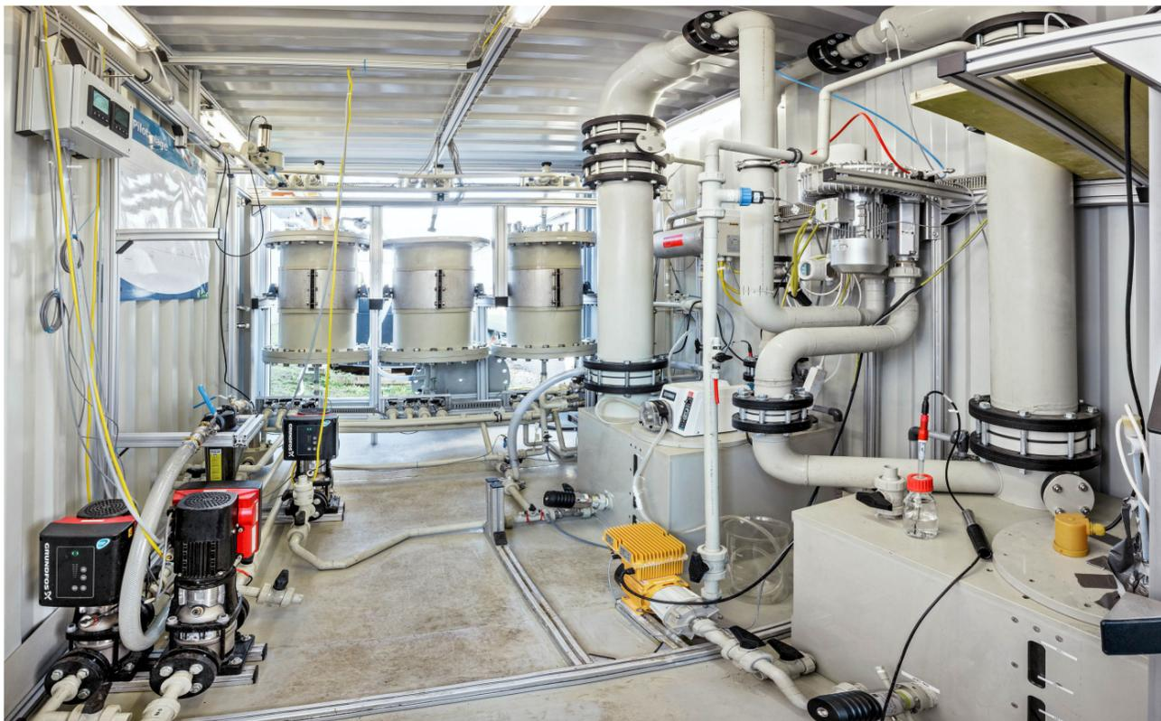
Abb.: Ionentauscher-Loop-Stripping-Verfahren (ILS) Pilotanlage, Innenansicht
