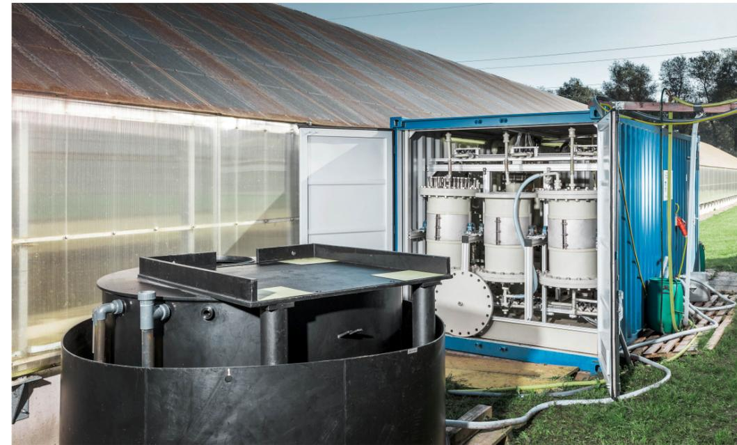
Abb.: Ionentauschkolonnen der ILS-Pilotanlage, Außenansicht
