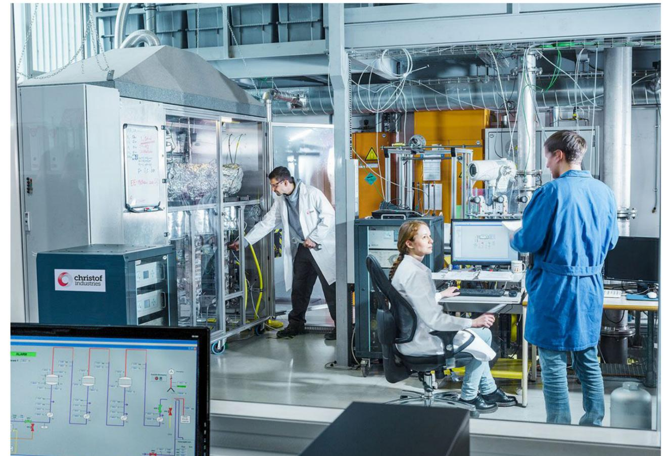
Abb.: 3-stufige katalytische Methanisierungsanlage
